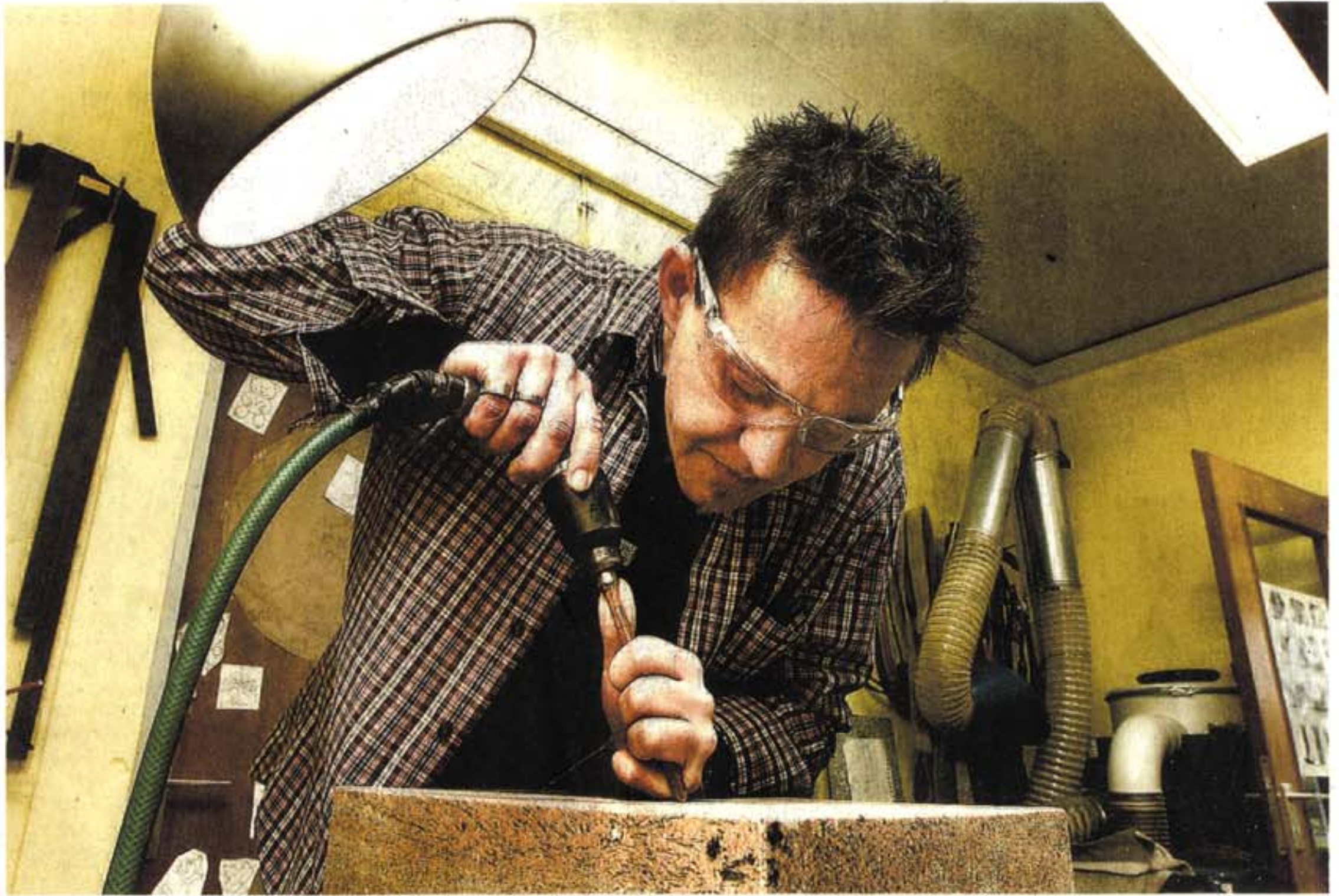
Der Hammer ist out bei den Steinmetzen. Dafür hat Ulrich Zacharzewski einen Meißel, der mit Druckluft betrieben wird.
